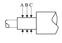
A. SHAFT RADIAL RUNOUT
